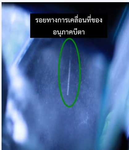
รูป รอยทางการเคลื่อนที่ของอนุภาคบีตาและแอลฟาในห้องหมอก
