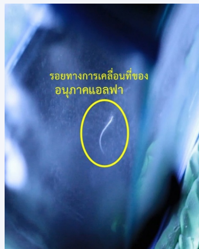
รูป รอยทางการเคลื่อนที่ของอนุภาคบีตาและแอลฟาในห้องหมอก
